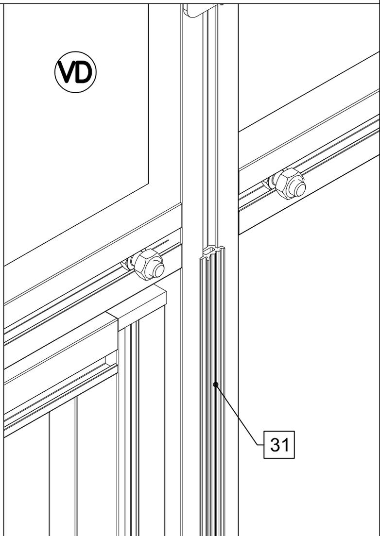
Übergänge zwischen Hohlkammerplatten und Profile im Dachbereich mit dem beiliegendem Silikon versiegeln.
