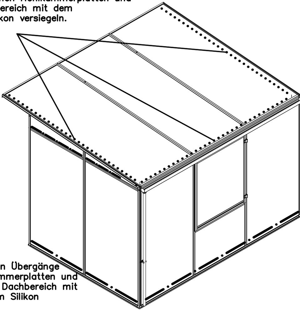
Alle waagerechten Übergänge zwischen Hohlkammerplatten und Profile sowie im Dachbereich mit dem beiliegendem Silikon versiegeln.
