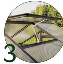
Breites Dachfenster mit automatischem Fensterheber: Öffnet und schließt sich selbstständig durch ein Öl-Wachsgemisch im Zylinder, das sich bei Wärme ausdehnt und bei sinkender Temperatur zusammenzieht.
