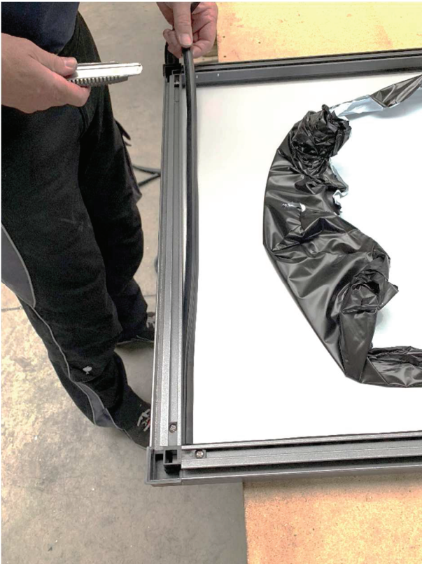
3. Kürzen Sie die Dichtung so, dass diese etwas länger ist als das Zwischenmaß. Zugabe siehe Zusatzblatt.
