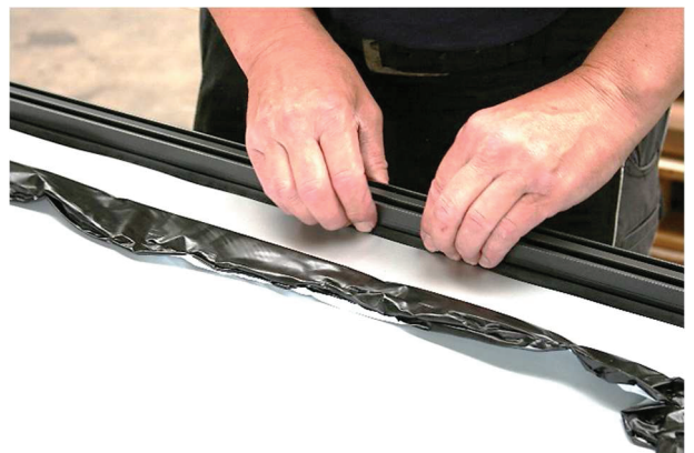
6. Die Dichtung auf der gesamten Länge des Profils gleichmäßig eindrücken und von außen zur Mitte hin stauchen.
